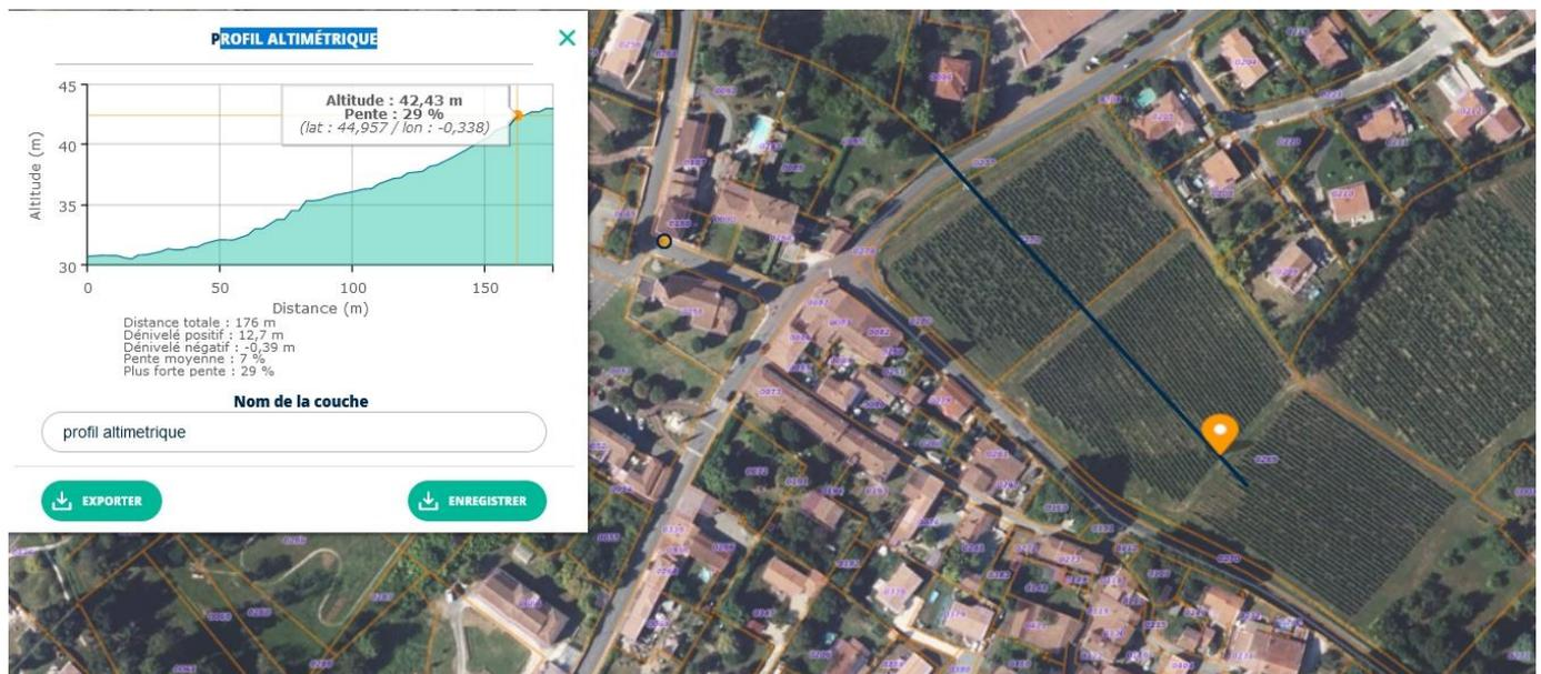
**Coupe de terrain (source Geoportail) montrant un dénivelé d'environ 12m entre le point le plus haut et le plus bas (route)**
